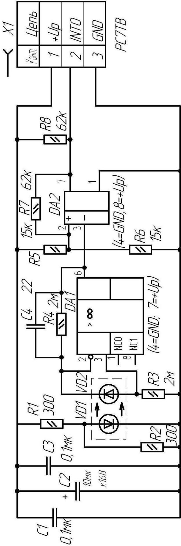
Рисунок А2 – Датчик ветра. Схема электрическая принципиальная
