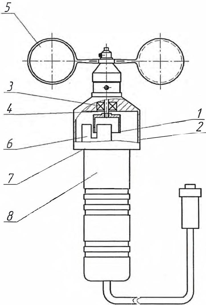
1 – обтюратор; 2 – корпус; 3 – подшипник; 4 – вал; 5 - вертушка;
