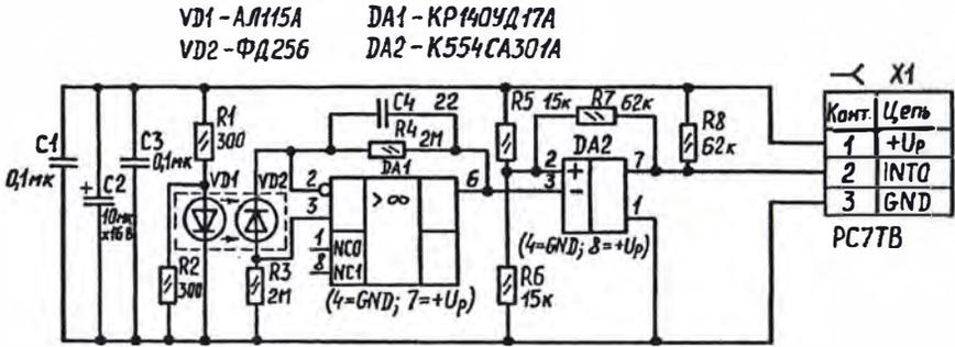
Рисунок 2 - Датчик ветра. Схема электрическая принципиальная
