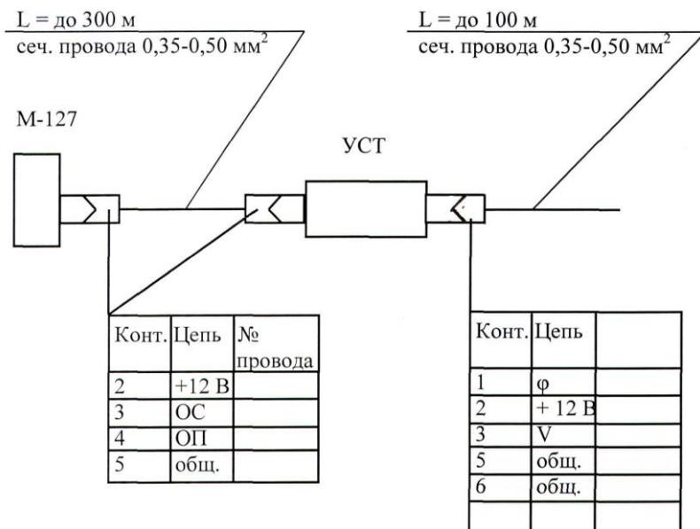
Рисунок 1 – Схема соединения устройства с датчиком
